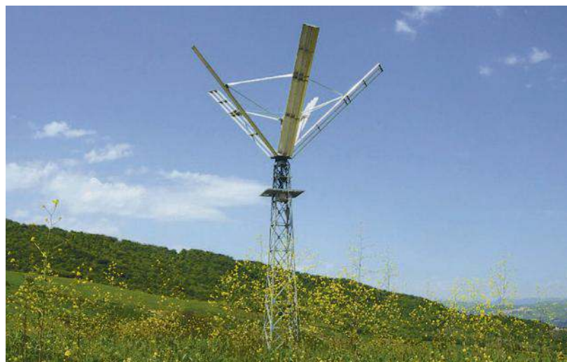
Turbine eoliche ELIWIND ® ad asse sub-verticale ibrido (VAWT) di ultima generazione ad alta producibilità e basso impatto ambientale
