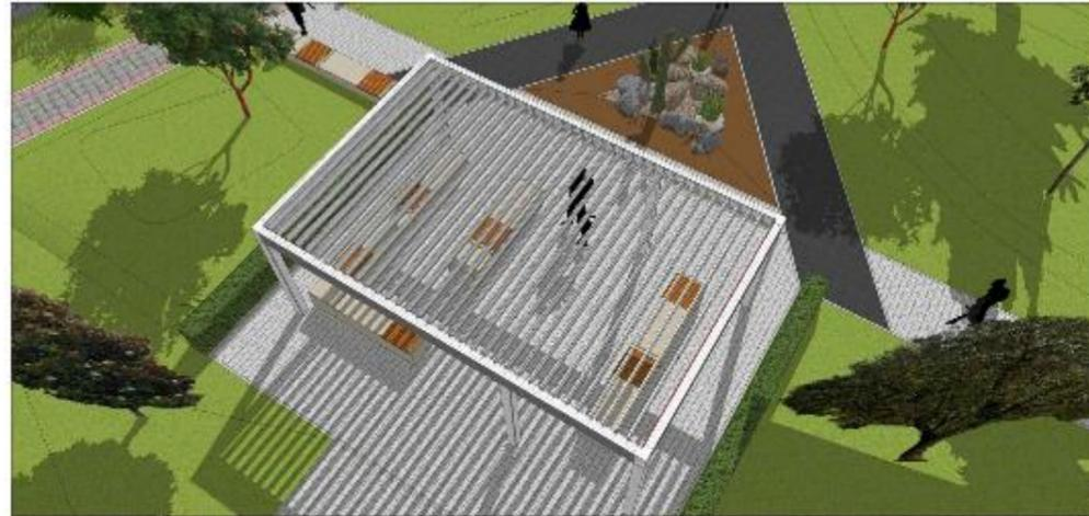
Pergola bioclimatica modulare con moduli affiancati o modulo accoppiato a tre gambe. Dimensioni per singola pergola 480 x 575 cm e 240 x 575 cm. Profili laterali di altezza 25 cm con possibilità di chiusure laterali retrattili motorizzate integrate all'interno del profilo. Gronde integrate alla struttura fissate al profilo portante.
