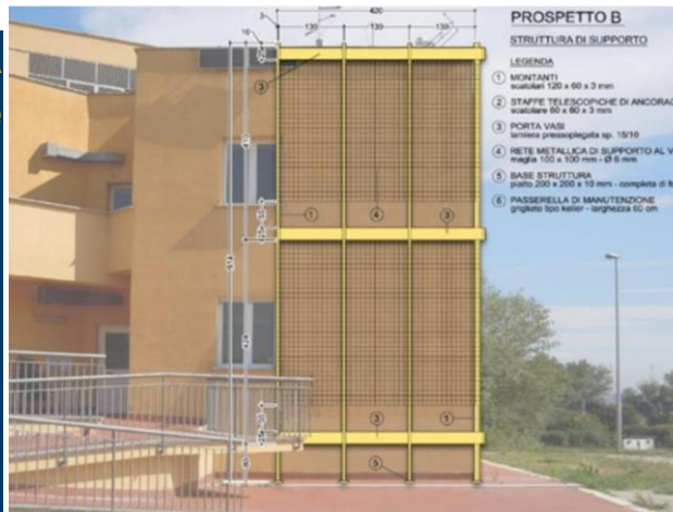
Prospetto della parete di Sud-Ovest
