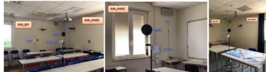
Sensori per le misurazioni interne all'edificio
