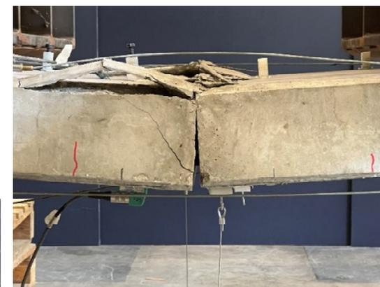
Il progetto ha consentito di realizzazione e testare dei prototipi di **elementi strutturali decostruibili** realizzati in **calcestruzzo con aggregati riciclati**. I risultati del progetto potranno promuovere lo sviluppo di nuovi sistemi costruttivi in grado di soddisfare molteplici esigenze per svariate applicazioni.
